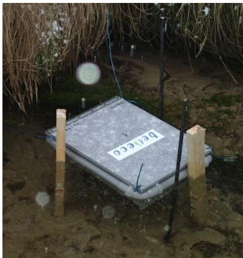
Obr. 13: Plovoucí schránka využívaná rybáři na Ašsku pro inkubaci jiker pstruha
