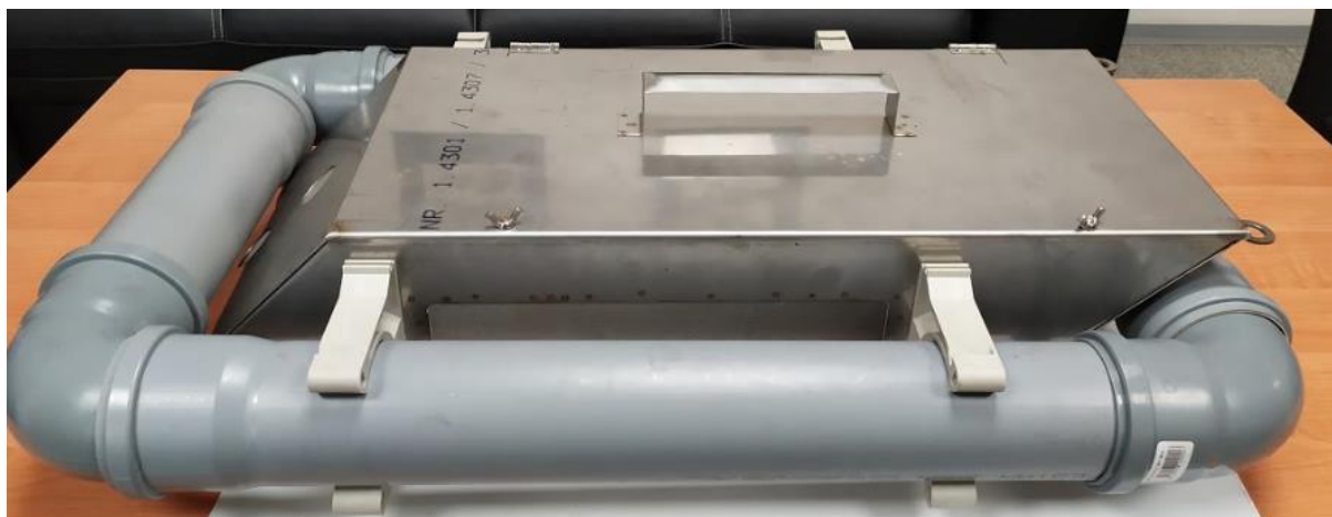
Obr. 5: Fotografie plovoucí modifikace LOSOSA GAMA (pravá strana schránky je návodní, tak aby ji proud nadnášel)
