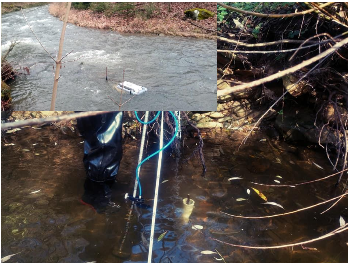
Obr. 27: Umístění monitorovacích čidel (teplota, konduktivita a výška hladiny)
